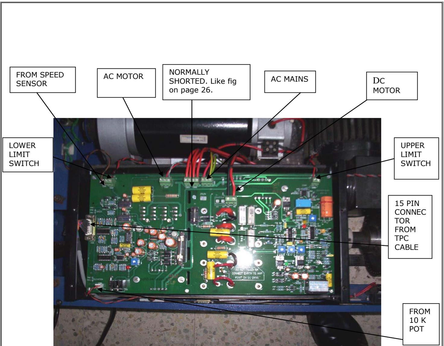
**Fig. 7 AC/DC COMBINED CARD CONNECTION**
