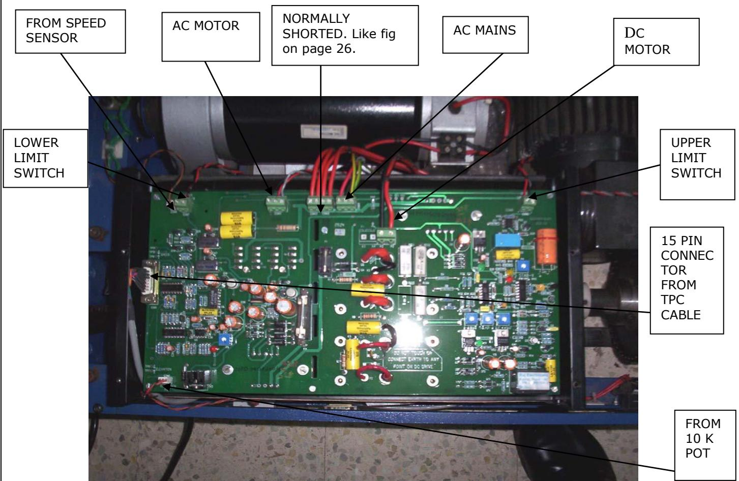
**Fig. 7 AC/DC COMBINED CARD CONNECTION**
